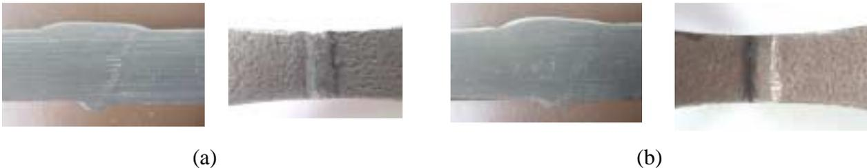
Figura 6 – Perfil e raiz da solda das amostras: (a) 9 e (b) 8.
