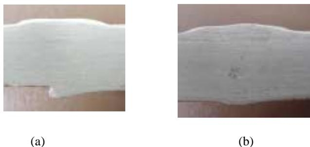
Figura 3 – Fotos das amostras com (a) discontinuidade geométrica na raiz da solda; (b) perfil de raiz uniforme.
