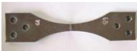
Figura 1 – Corpo de prova para ensaio de fadiga.
