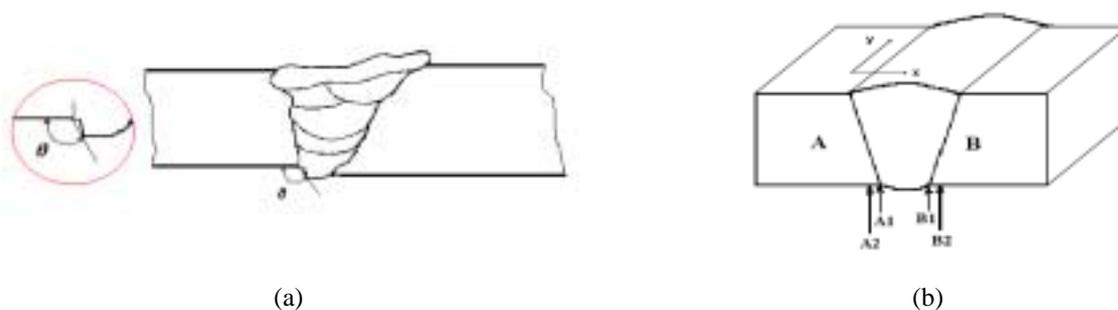
Figura 2 – Ilustrações esquemáticas (a) ângulo de convexidade medido na raiz da solda; (b) locais da raiz da junta soldada onde as medidas de raios-X foram conduzidas.
